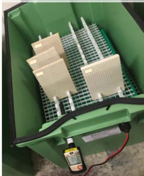
Bild 1. Magnesiumoxidskivor i en låda med ett konstant klimat, 20 °C och 85 % RF.
